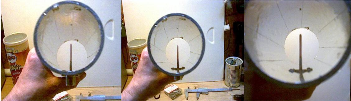
**Figuras 39-40-41. Aspecto del ensamblado N-Hembra.**
