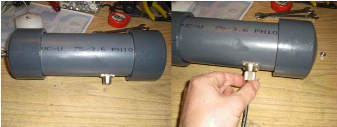
**Figura 60-61. Cierre de la antena, y roscado del conector listo para usar.**
