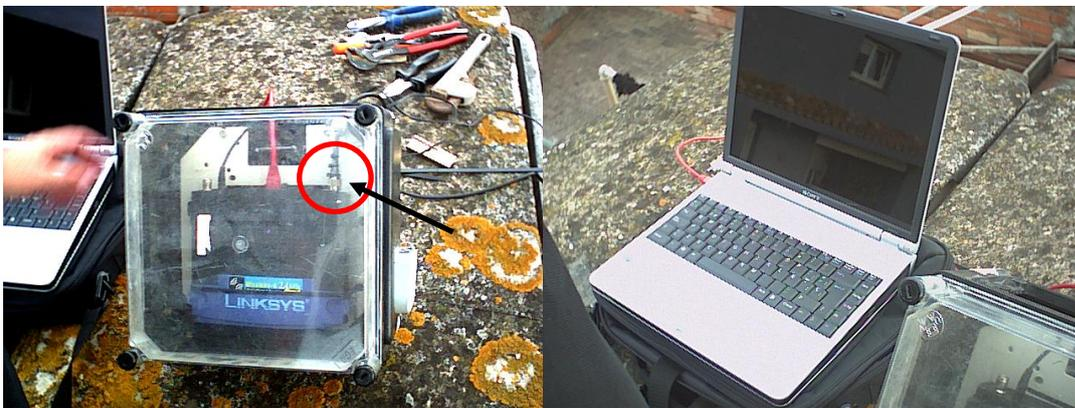
**Figura 64-65 Conexión del router al portátil, y del router a la antena**
