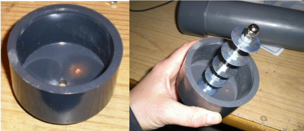
**Figuras-48-49. Perforación del tapón, y montaje del colector.**
