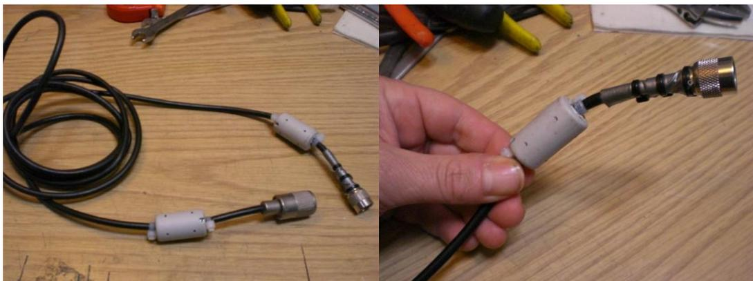
**Figura 62-63. Detalle del cable WIFI con filtros antiparásitos.**
