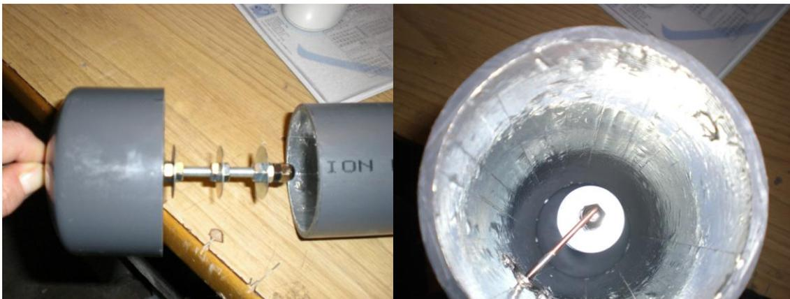
**Figura-50-51. Inserción del tapón, y calibración de la distancia del colector al Solenoide.**
